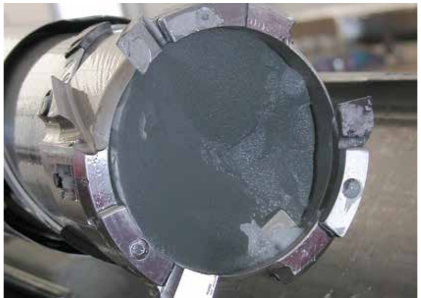
Trivellatrice con carota di ghiaccio di 10 centimetri di diametro della stazione Dome C nell'Antartide. © Jakob Schwander, Università di Berna
